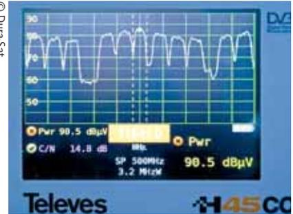
Abb. 5: Das Hotbirdspektrum um den Transponder 11541 MHz Vertikal mit dem Programm „DAS ERSTE“ ist mustergültig
