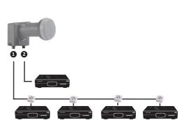
SCR Ausgang für bis zu 4 Receiver/TV im Unicable I SAT-Betrieb.
