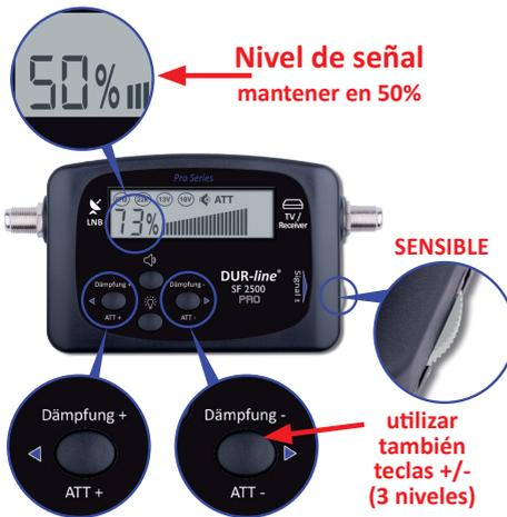
Mantener el rango de visualización del nivel de señal en torno al 50%, para ello aumentar o reducir la atenuación. Así se puede detectar si el nivel aumenta o disminuye. Cuando la atenuación está activada, la pantalla muestra «ATT».
