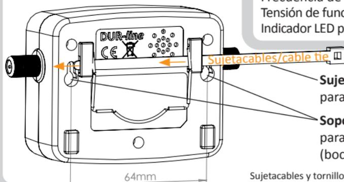
Sujetacables para la fijación a un mástil
