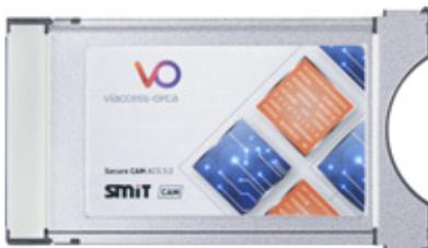
Viaccess CI Modul für MPEG-4/MPEG-2 und HDTV Viaccess verschlüsselte Kanäle. Das Modul entschlüsselt zusätzlich verschlüsselte TV-Programme, die über ACS 4.x codiert wurden (kompatibel mit vorherigen Versionen).
