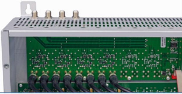
Ausgänge, USB- und LAN-Anschluss sowie Lüfter auf der Unterseite des Geräts
